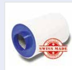
I Carbon Active sono prodotti con una nuova tecnologia: in questi filtri il carbone attivo viene polverizzato ed inserito in una stuovia filtrante. Questo procedimento di frazionamento del carbone aumenta la capacità di assorbimento degli odori e riduce le perdite di pressione rispetto ai filtri tradizionali.
