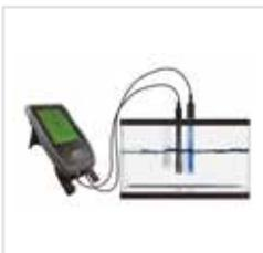
L'HydroMaster è un monitor per il controllo in continuo del pH, della conducibilità elettrica (EC) e della temperatura con una precisione molto elevata. Lo strumento può anche misurare i solidi totali disciolti (TDS). Questo strumento può essere calibrato con varie soluzioni tampone ed è dotato di riconoscimento automatico del tampone per garantire la facilità di taratura all'utente.
