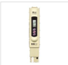
Misuratore di EC ideale per uso commerciale. Altamente efficiente e accurato grazie alla tecnologia avanzata del suo microprocessore. Funzione di spegnimento automatico dopo 10 minuti di non utilizzo per preservare le batterie. Termometro digitale incorporato.
