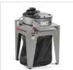
MT Gentle è un trimmer progettato per i coltivatori che cercano una macchina che funzioni in modo più automatico, grazie al suo contenitore di carico e alle dita in silicone, che muovono e ruotano le cime sulla griglia.
