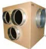
Aspiratori cassonati insonorizzati con motore elettrico direttamente accoppiato. Struttura della cassa in pannelli di lamiera o MDF con pannelli insonorizzanti. Dotati di pannelli laterali di ispezione. Il motore è montato su appositi giunti antivibranti per ridurre al minimo i rumori parassiti. I prodotti vengono venduti cablati con cavo e spina.
