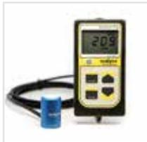
Il misuratore di flusso fotonico è lo strumento preferito dagli scienziati di tutto il mondo per misurare con precisione la radiazione fotosinteticamente attiva da tutte le sorgenti luminose. Ha un misuratore portatile, collegato tramite cavo, che visualizza e memorizza le misurazioni. Il sensore incorpora un fotodiode in silicio potenziato dal blu e filtri ottici personalizzati con un design dell'alloggiamento
