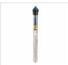
Il riscaldatore di controllo Eden 425 è caratterizzato dal fatto che l'elemento bimetallico non è attraversato dalla corrente elettrica. In questo modo è impossibile che il bimetallo si riscaldi e falsi il termostato. Ciò garantisce che la temperatura impostata venga mantenuta e che venga raggiunto un livello di temperatura uniforme.
