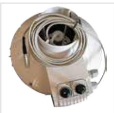
Aspiratore centrifugo VK con Fan Controller integrato e sonda remota con cavo di 3 metri. Il sistema è dotato di una manopola per il controllo della velocità di rotazione del motore ed una per il controllo del termostato (tra 20° e 30°C).
