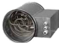
Riscaldatore da condotta adatto ad essere combinato con aspiratori elicoidali o centrifughi. Il corpo è acciaio zincato mentre le resistenze sono in acciaio inox. I riscaldatori per condotte NK sono dotati di due rilevatori di temperatura per il funzionamento e la protezione contro il surriscaldamento.
