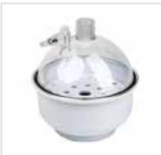
Essiccatori a prova di implosione; sop-
