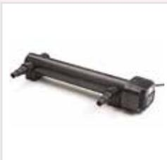
Il Vitronic è uno sterilizzatore a raggi UV-C che elimina le alghe in sospensione, i germi e i batteri nocivi. Il Vitronic lavora con una lampada a raggi UVC che deve essere sostituita preferibilmente ogni primavera. Il filtro per la dechlorazione dell'acqua e l'eliminazione dei metalli pesanti è composto da una cartuccia in linea adatta a trattare fino a 200.000 litri di acqua. Contiene all'interno carbone attivo di alta qualità.
