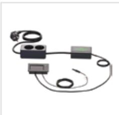
Termostato digitale per l'automazione di cavi riscaldanti e tappeti riscaldati e impianti di illuminazione. Questo dispositivo è dotato di due relè con un nominale max. carico di 10A ciascuno. Si consiglia un carico massimo totale di 1200W. I relè non sono progettati per commutare carichi induttivi come ad esempio ballast magnetici mentre può accendere ballast elettronici. Fornito di ampio display per la visualizzazione dei parametri ambientali.
