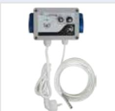
Timer per automatizzare il funzionamento di pompe ad acqua e aria in impianti di irrigazione e ossigenazione. Adatto ad alimentare pompe fino a 10 A. Dotato di sonda di 4 metri con sensore fotoelettrico per capire se l'ambiente è illuminato o al buio. Possibilità di settare la frequenza di irrigazione da 1 s a 16 ore e la durata di ogni singola irrigazione da 1 secondo a 20 minuti.
