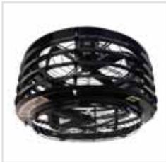
**ELITURBO ELC2000** è un miscelatore – destratificatore d'aria in grado di uniformare in verticale e in orizzontale la temperatura e l'umidità dell'aria all'interno di grandi ambienti e di ridurre fino al 40% il costo energetico necessario per il loro riscaldamento. ELITURBO impiega una speciale girante elicentrica brevettata dalla Impresind che genera la completa miscelazione dell'aria dell'ambiente senza produrre correnti fastidiose per le persone, e, a
