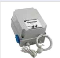
Fancontroller progettato per far lavorare al meglio gli impianti di trattamento dell'aria; un trasformatore a step GSE controlla la velocità del ventilatore automaticamente, aumentando o diminuendo la velocità di rotazione degli aspiratori ad esso collegati secondo dei parametri ambientali impostati, quali temperatura e umidità relativa.
